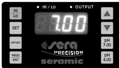
**pH 7** Spülen Sie die Elektrode mit Destwasser ab und stecken Sie diese in die grüne **sera Prüflösung pH 7,0**. Warten Sie mindestens 60 Sekunden. Drücken Sie gleichzeitig die Tasten
